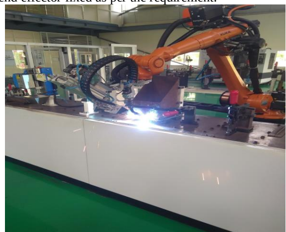
Fig. 5. MIG Welding 8-axis Kuka Robot
