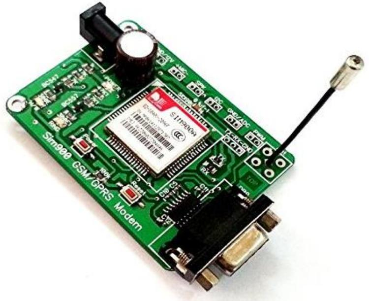
Fig. 5. GSM SIM900A
