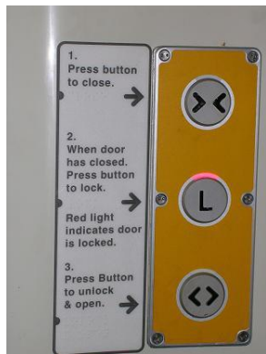
Fig. 5 Automatic Lavatory door
